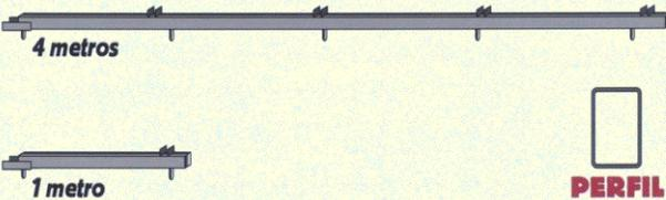
SISTEMA DE ENCOFRADO DE PLANTA, FACIL DE MONTAR Y RECUPERABLE EN EL 90% DE SUS PIEZAS, YA QUE SOLO SE DEJA EN EL FORJADO LOS RECUPERADORES CON SUS CORRESPONDIENTES PUNTALES.
